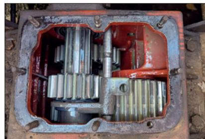
Geöffnetes Wendegetriebe des Klv 053 während der Reparatur.
