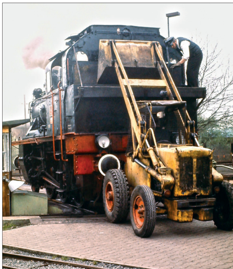
Elna 146 am 30. April 1977 beim Bekohlen mit einem Radlader in Bochum-Dahlhausen.
