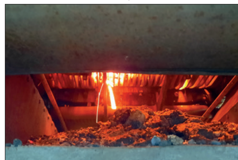
Blick in den Aschkasten von Lok 378.78 beim Ausschlacken nach Ausbau des Funkenschutzgitters.
