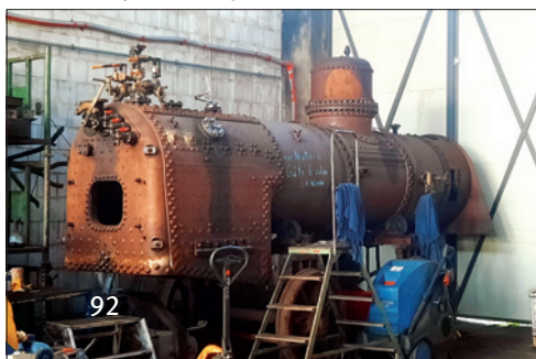
Der Kessel der T 3 wurde so weit komplettiert, dass eine Kaltwasser-Druckprobe durchgeführt werden konnte.
