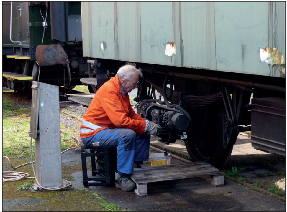
Michael Brod bei der Demontage der zwei Lichtmaschinen, um den Radsatzausbau zu ermöglichen.
