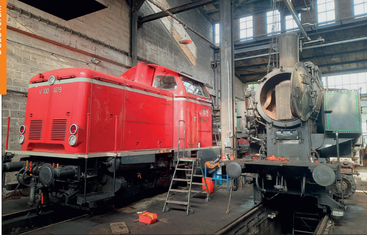
Die Montage der Stehkesselverkleidung war wegen der unzähligen kleinen Schrauben und schlechtsitzender Bleche eine sehr mühsame Angelegenheit, die sichtlich wenig Spaß bereitet hatte.
