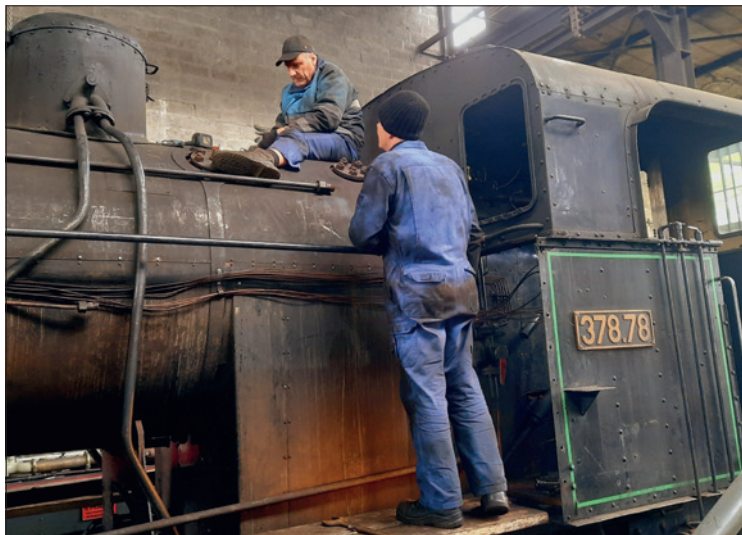
Die Montage der Stehkesselverkleidung war wegen der unzähligen kleinen Schrauben und schlechtsitzender Bleche eine sehr mühsame Angelegenheit, die sichtlich wenig Spaß bereitet hatte.
