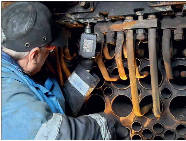
Michael Ihrig beim Polieren der Anschlussbohrungen des Dampfsammelkastens. Jürgen Lemke (2)
