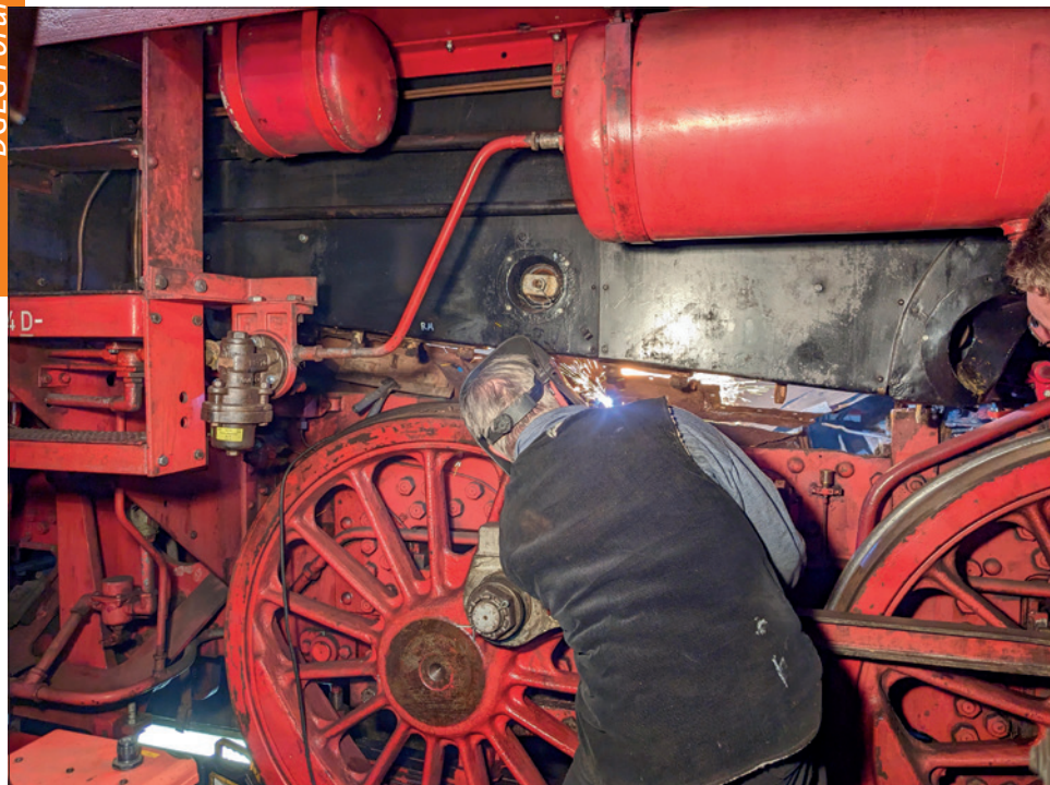
Ausbau des Aschkasten unserer 52er (Bild links) und Aufarbeitung der Köf. Christian Krodell (2)
