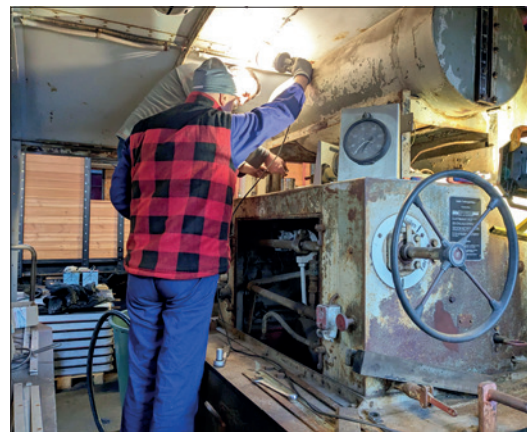
Ausbau des Aschkasten unserer 52er (Bild links) und Aufarbeitung der Köf. Christian Krodell (2)
