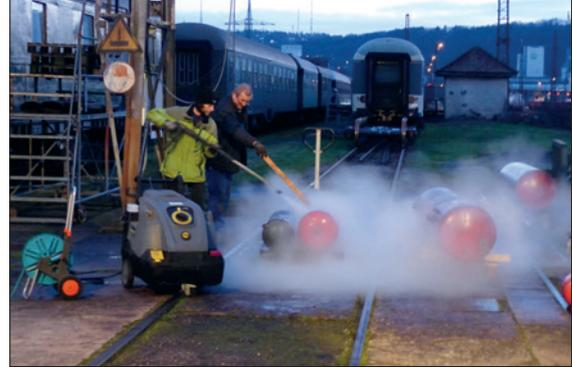
Simon bei Reinigungsarbeiten am Ci bay 30. – Die Luftbehälter vom Tender werden von Christian zum Dampfstrahlen vorbereitet. – Simon und Dieter reinigen die Luftbehälter mit Dampfstrahl.
