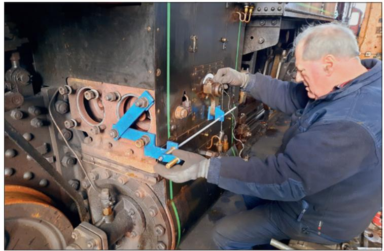
Blick auf die unverkleidete Stehkesselseitenwand der Lok 378.78. – Gerhard Hitschler beim Überprüfen und Einstellen der Ventilsteuerung. Jürgen Lemke (2)
