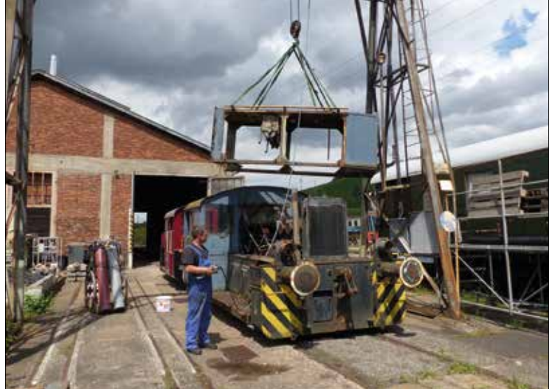
Ausbau des Getriebes aus der Köf II, gebaut von der Klöckner Humboldt Deutz A.G. Köln, für die Eisenwerke Friedrich Wilhelm Düker AG.
