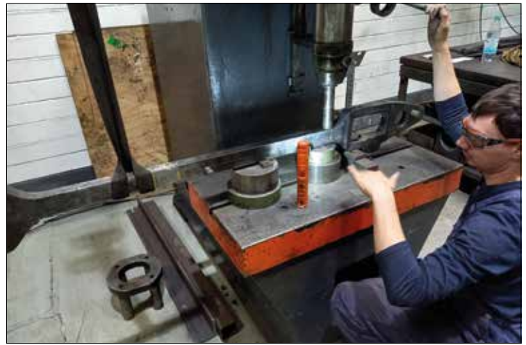
Matthias Dähling bei der Demontage der schadhaften Gestängebauteile (links). Die verbogenen Kuppelstangen wurden nach dem Glühen mittels dieser hydraulischen Presse wieder in ihre ursprüngliche Form gebracht (rechts).
