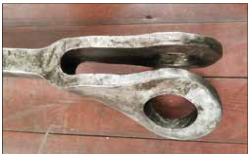
Die Gabel der ersten Kuppelstange wurde beim Verkanten ihres Kuppelbolzens besonders stark deformiert. Oliver Brückom
