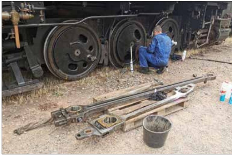
Matthias Dähling bei der Demontage der schadhaften Gestängebauteile (links). Die verbogenen Kuppelstangen wurden nach dem Glühen mittels dieser hydraulischen Presse wieder in ihre ursprüngliche Form gebracht (rechts).
