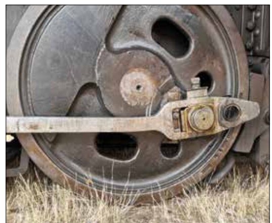
Bei der Hauptkuppelstange wurde der vordere Stangenkopf nach oben weggebogen. O. Brückom
