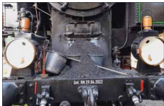
OBE Pfiffige Lösung: Die Lösche wird in einem rechteckigen Behälter unterhalb der eigentlichen Rauchkammer gesammelt. Dies erleichtert die Reinigung und die Rohrwand bleibt sauber und trocken.
