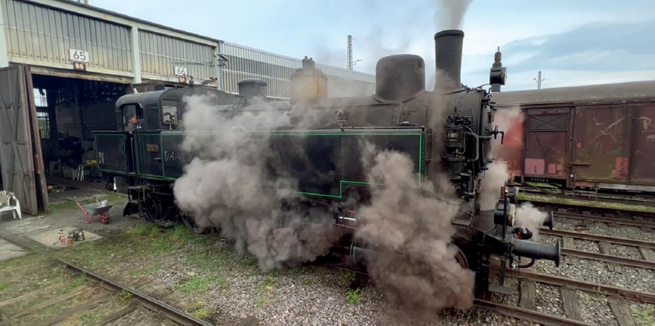
Nach Ausbau der Steuerventile wurden die vom Regler kommenden Rohrleitungen mit viel Dampf ausgeblasen und so von Rost und Fremdkörpern befreit.
