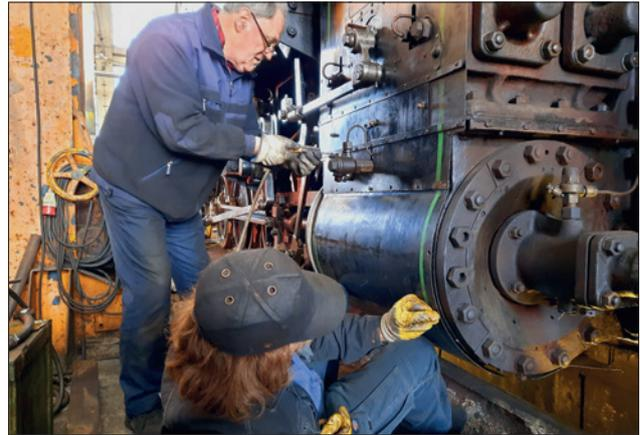
Gerhard Hitschler (o) und Marcus Klein (u) beim Wiederaufbau der Zylinderverkleidung mittels winziger Senkkopfschrauben M6x8!
