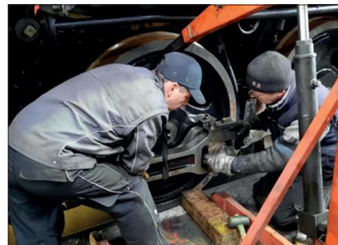
Matthias Dähling beim Einbau eines neuen Bläasers in Lok 378.78 (gr. Foto). Da Lok 378.78 moderne Bremsähne mit Rastfunktion erhielt, mussten hierfür unauffällige Verdrehsicherungen angefertigt werden (oben rechts). Andreas Schulz (links) und Ralf Rudolph bei der Montage des linken Triebstangenlagers der 378.78 (darunter).
