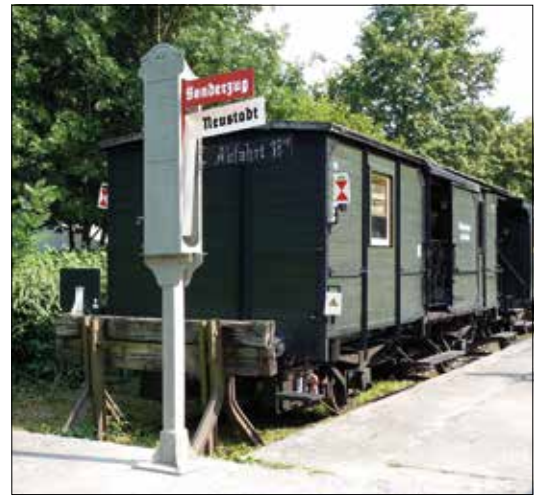
Zugzielanzeiger im Bahnhof Elmstein: Seine Bedienung obliegt dem Zugführer, der auch immer die nächste Abfahrtszeit mit Kreide anzuschreiben hat.
