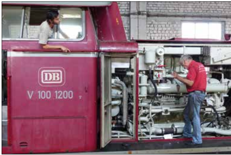
Günter Rölting und Simon Schellhorn bei der Kompressionsüberprüfung des Motors MB 12 V 652 TA 10 unserer V 100.
