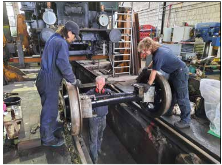
Sebastian Strauß, Markus Walle und Marcus Klein (von links) rollen den ersten einbaufertigen Radsatz vor die Lok 378.78.
