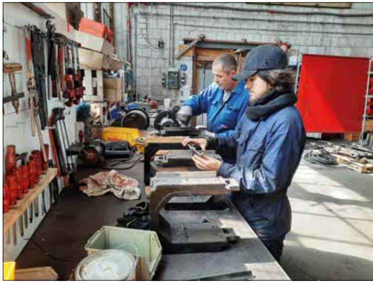
Sebastian Strauß (vorn) und Matthias Dähling (hinten) beim Nachschneiden aller Gewindebohrungen der Achslagerkästen. Jürgen Lemke (3)
