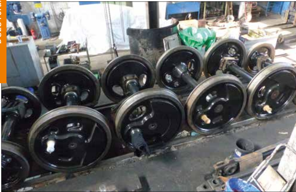
Blick auf die fast einbaufertige Radsatzgruppe. Lediglich der zweite Kuppelradsatz harrt noch seiner Achslagerkästen.
