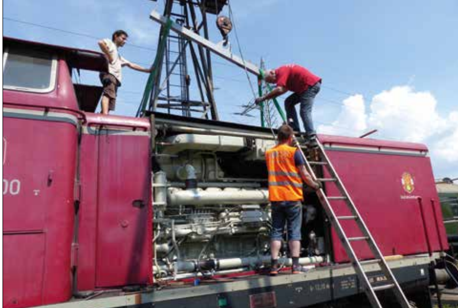
Probemontage der Motorhaubenabdeckung der V 100 durch Simon Schellhorn, Günter Röling und Stefan Gärditz. Links: Christian Sultan arbeitet am Ci bay 30. Helmuth Hombach, Christian Krodell
