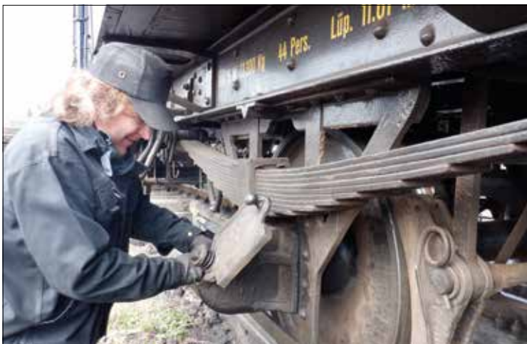
Marcus Klein bei der alljährlichen Überprüfung eines Gleitlagers.
