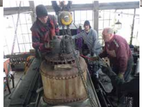
Blick in den Rundlokschuppen mit der aufgebockten Lok 378.78 „Sissi“ (oben). Um an den Regler der „Sissi“ heranzukommen, muss nur diese relativ kleine Flanschplatte mit den beiden Sicherheitsventilen abgehoben werden (rechts).
