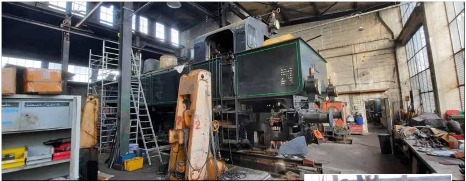
Blick in den Rundlokschuppen mit der aufgebockten Lok 378.78 „Sissi“ (oben). Um an den Regler der „Sissi“ heranzukommen, muss nur diese relativ kleine Flanschplatte mit den beiden Sicherheitsventilen abgehoben werden (rechts).
