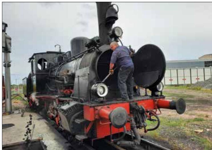
Rauchkammer und Aschkasten werden nach jeder Fahrt gründlich gereinigt, um Korrosionsschäden vorzubeugen. Jürgen Lemke (2)
